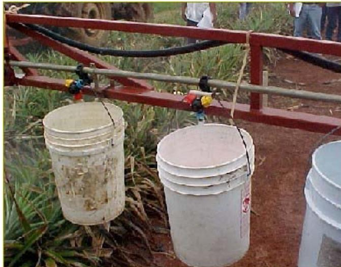
En la calibración no solo hay que determinar la cantidad de producto que se aplica por unidad de área, sino que tiene que estar en movimiento por lo irregular del terreno.
