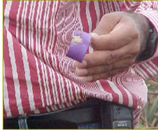
Con el uso del papel hidrosensible se determina el destino de la gota de la mezcla aplicada, el tamaño de la misma y si la cobertura es la adecuada.
