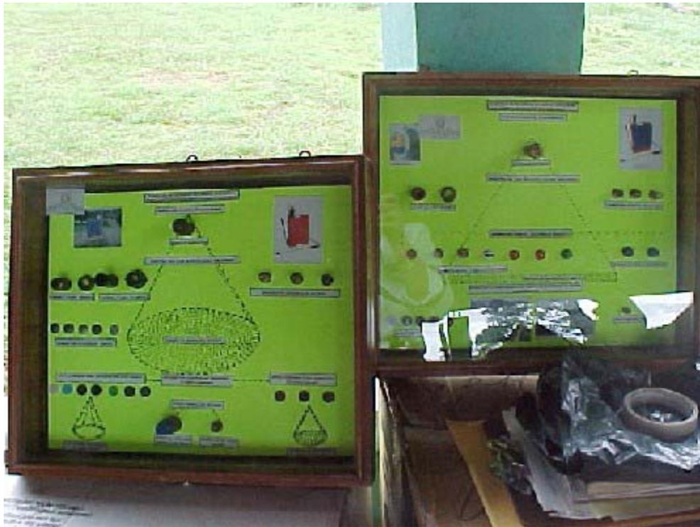
Las boquillas, son consideradas elementos de medición. Cada una de ellas tiene un uso y una descarga que se calcula con base a una presión específica.
