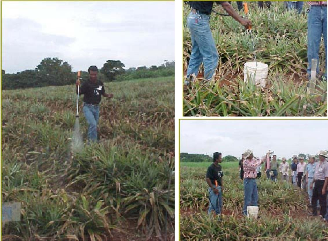
La secuencia de las fotos muestra el procedimiento utilizado en la práctica de campo para determinar la cantidad de líquido que se está aplicando con el tipo de equipo señalado.
